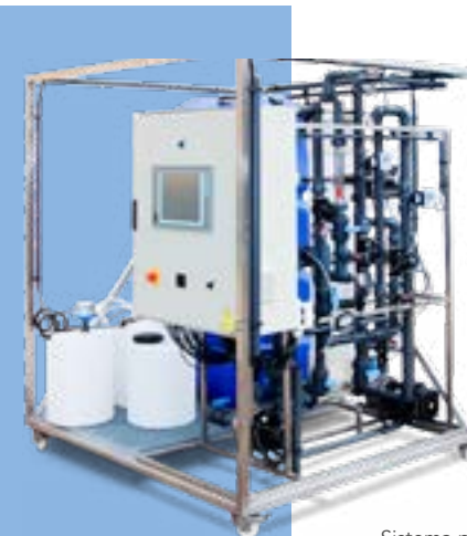
Sistema piloto de Ultrafiltración
