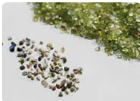
Exemple du verre de mauvaise qualité: les impuretés séparées d'un échantillon
